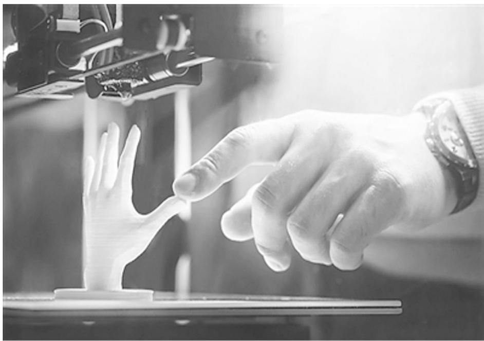
3D打印工艺是指由机器自主“打印”连续的一层层软性、液体或粉末状材料,这些材料会迅速硬化或融合,从而形成三维固态物体。自20世纪80年代问世以来,3D打印技术已经取得长足进步,广泛应用于制造、医疗、航空航天等领域。科学家们利用3D打印技术打印出了火箭、食品,甚至直接在人体内3D打印生物材料。
