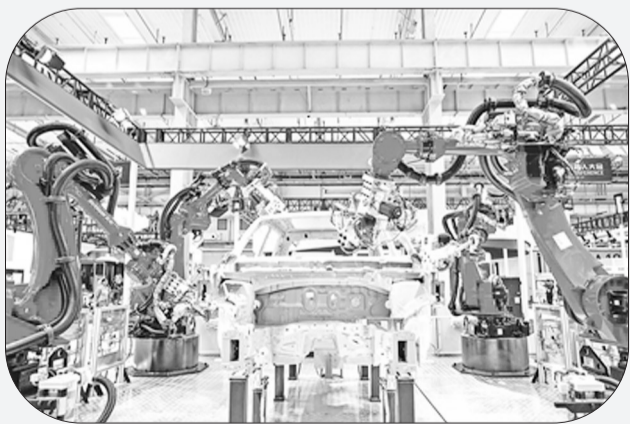
8月16日拍摄的白车身焊点机器人工作站。当日,2023世界机器人大会在北京开幕,本次大会的主题为“开放创新聚享未来”,包含论坛、博览会、机器人大赛等活动。
