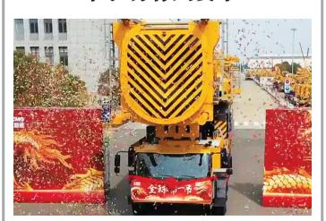
近日,4000吨级全球最大轮式起重机在位于江苏徐州的徐工 集团发车,正式交付。该起重机能够满足在170米的吊装高度 时,230吨的极限吊装重量。该起重机运用高性能柔性臂架技术, 能有效解决超高大功率风机安装难题,同时利用自主研发的控制系 统以及主动安全技术,能及时排除影响施工的安全隐患。新华社发
