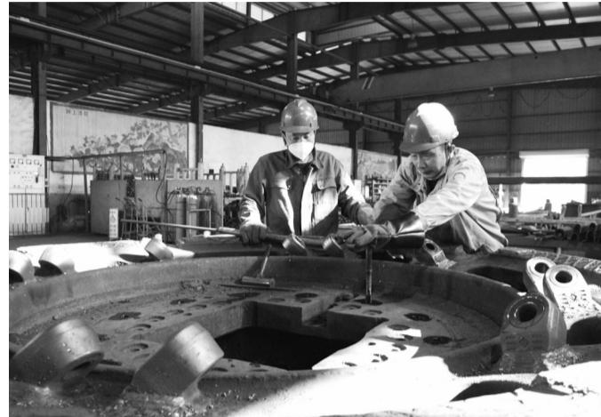
4月间,在中煤新集设备维修公司一矿综修车间铆焊班,闪闪的弧光像烟花一般此起彼伏,照亮了整个厂房。烟尘净化器宛如一只只巨兽,伸着长长的脖子,将焊接产生的烟雾一股脑地吞进肚子里。在厂房安全通道西侧,铆焊班职工曹孟汉和胡敬波两位技师正密切配合,精心焊接着采煤机滚筒齿座。他们一边细心测量确定着齿座的大致位置,用点焊初步固定,一边反复微调着齿座间的距离与角度,并不时拿出纸笔记录、计算着。已经焊好的齿座焊缝均匀而光滑,一层压着一层,就像小鱼的鳞片一样,非常好看。
