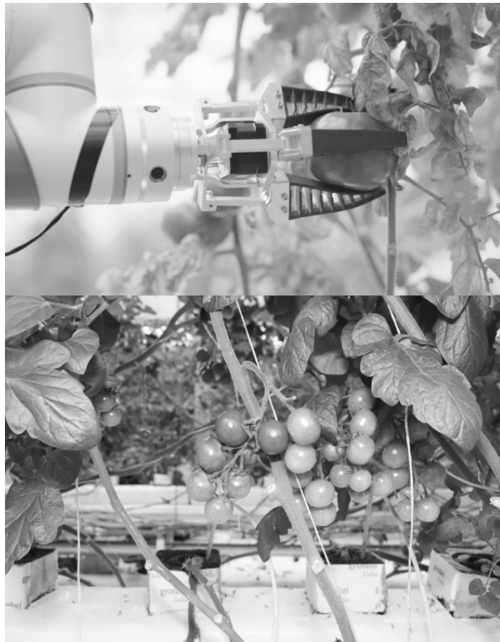
江苏省农科院智慧农业创新团队使用研发的采摘机器人开展番茄采摘作业实验。
