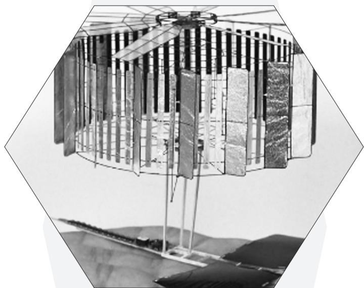
北京航空航天大学科研团队利用自主开发的新型静电电机,成功研制出仅重4.21克的太阳能动力微型无人机,实现纯自然光供能下的持续飞行。相关成果日前在国际学术期刊《自然》发表。
