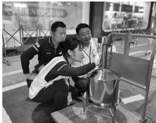
为维护“计量准确 质量合格”的品牌形象,保障消费者权益,中石化淮南分公司强化加油机校验工作。每月对辖区内加油机至少进行一次周期性校验,工作人员使用20升标准计量桶,严格依据加油机检定规程,全面检查校准加油机流量、示值误差和重复性。此外,公司还组建专业团队随机抽查,重点检查加油机
